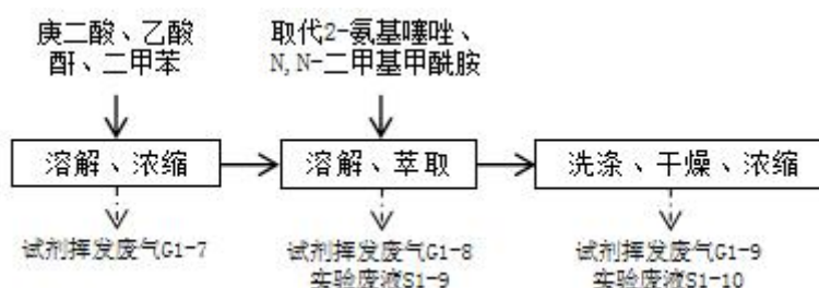
图 3-3 项目合成工艺流程及产排污环节
